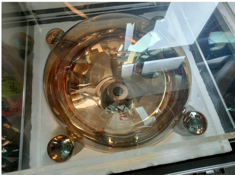
图 1.6 20 寸 MCP-PMT 与环绕的 4 个 3 寸 MCP-PMT
