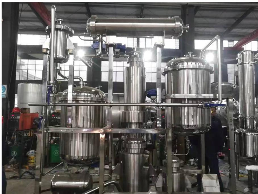
图 3.5 锦屏中微子实验原型机蒸馏提纯设备图
