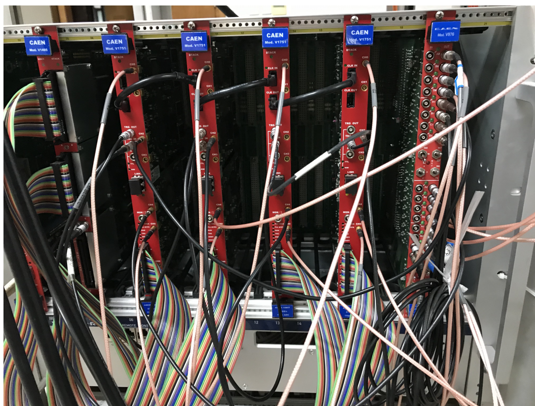
图 3.4 复现的锦屏1t采数系统（最右侧是用于产生 14 路信号的复制板 V976）
