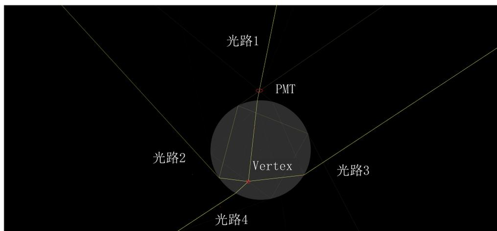
图 4.5 击中同一个 PMT 的不同光路示意图
